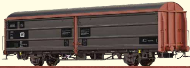
Schiebewandwagen Hbis-x 299 DB Betriebs-Nr. 21 80 225 6492-8
